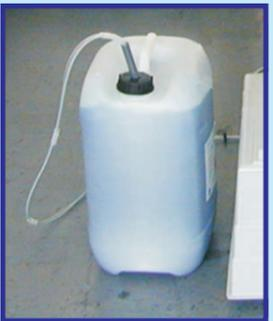
7) Sistemazione della sonda di aspirazione dell'acido nel fustino di ACIQUEST
