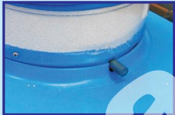
4) assicurarsi che il perno di posizionamento coincida con la scanalatura del supporto
