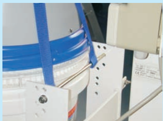
4) assicurarsi che l'asta di sostegno sia posta nella scanalatura del fustino
