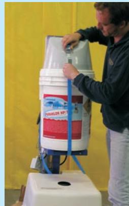
3) Sistemazione e fissaggio del fustino sul supporto
