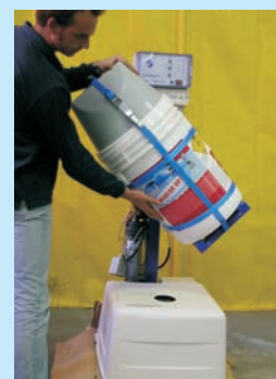
5) Rotazione del fustino. Far coincidere l'uscita del prodotto con la vaschetta di miscelazione
