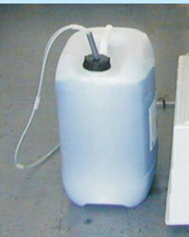
7) Sistemazione della sonda di aspirazione dell'acido nel fustino di ACIQEST
